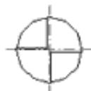
Muy recomendable en el caso de tornillos de seguridad ya que permite el atornillado pero no el desatornillado.
