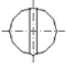
Primer sistema utilizado actualmente en desuso ya que con frecuencia se escapa el destornillador durante la fase de atornillado. Se utiliza principalmente en el sector eléctrico.
